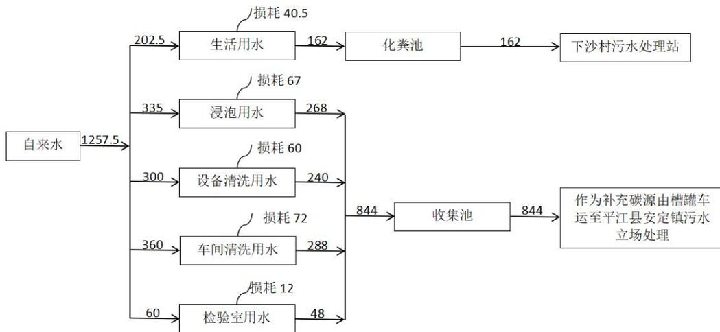
图 2-1 近期水平衡图 (单位:  $\text{m}^3/\text{a}$ )
